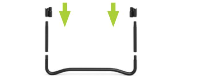
**3** Anschließend verbinden Sie die Standfüße mit den Rahmenteilen. Vergewissern Sie sich, dass der freie Teil des Verbindungsstücks zur Innenseite des Rahmenkreises gedreht ist. Drehen Sie die Standfußverlängerung, bis das AkroClick-System einrastet und eine stabile Verbindung bildet, sodass der Fuß nicht mehr herausrutschen kann. Fahren Sie mit der Montage des Rahmens fort, indem Sie die Rahmenteile mit und ohne Muffen abwechselnd zusammensetzen, bis ein Kreis entsteht.
